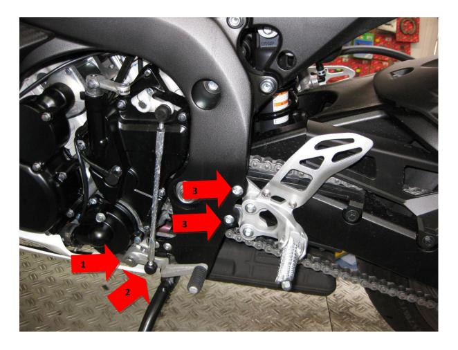
SACHEZ QUE CHAQUE ASSEMBLAGE FOURNI EST ASSEMBLÉ LIBREMENT. UN MONTAGE COMPLET NÉCESSITERA LE SERRAGE DE CHAQUE BOULON AU COUPLE RECOMMANDÉ AVEC L'ADDITION D'UN COMPOSÉ DE BLOCAGE DE FILET - TEL QUE R&G THREAD LOCK.
