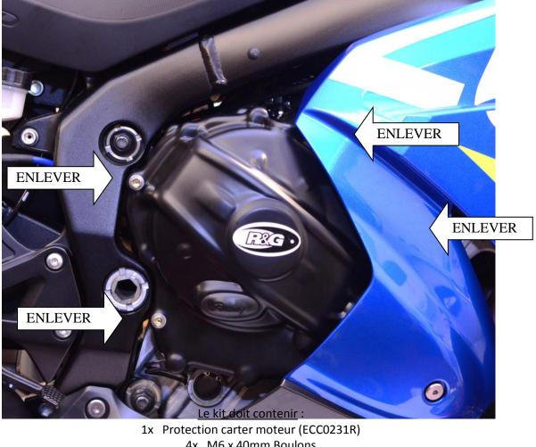
4x M6 x 40mm Boulons 1x Palet de course (SK0001SK (Déjà monté)). 2x Ecrous PAL (Déjà monté).
